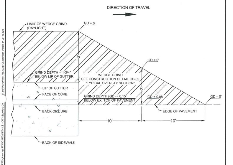
WEDGE GRIND TRANSITION AT LIP OF GUTTER TO EDGE OF PAVEMENT
